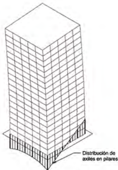
Fig. 5. Deformada típica de una estructura tipo tubo
